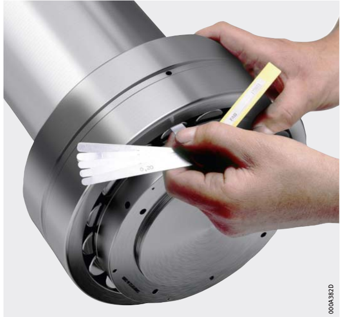
Bild 12 Verminderte Radialluft messen
